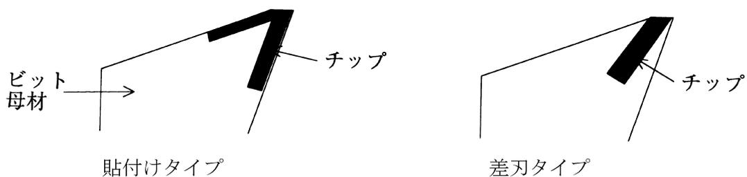
図-4. 9 超硬チップの取り付け方による分類
