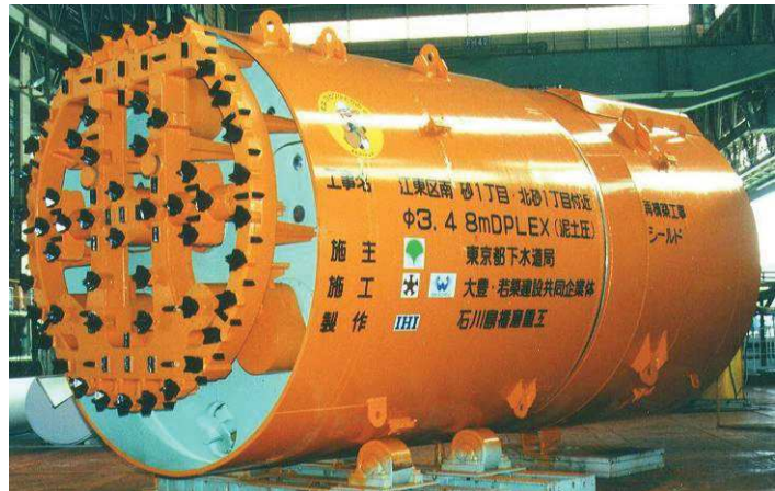
写真-1. 1. 1 円形断面偏心多軸シールド
