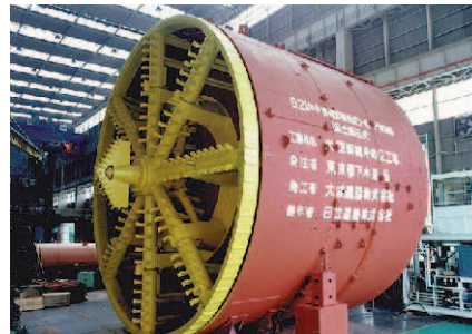
東京都太田幹線その2工事 ▲ (シールド径: φ 8.21m)
