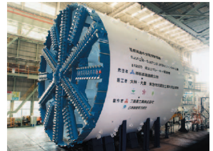
首都高速中央環状新宿線(外回り) トンネル工事 ▲ (シールド外径: φ 12.02m)
