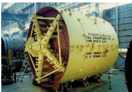
東京電力京浜潮田線管路工事 ▲ (シールド径: φ 5.03m)
