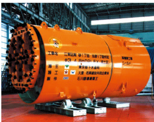
江東区南砂 1 丁目、北砂 1 丁目付近再構築工事 シールド外径: φ3.48m (東京都下水道局)
