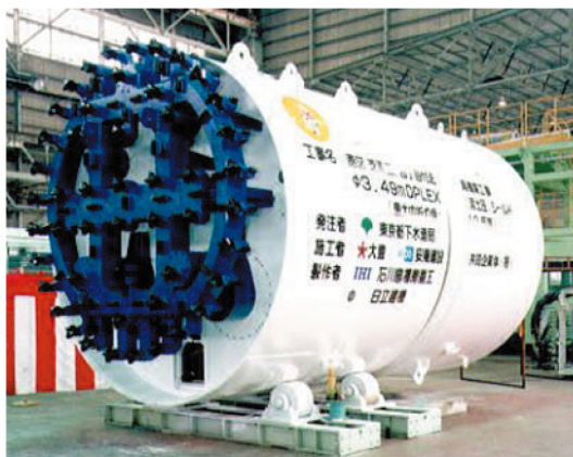
港区芝浦 2, 4 丁目付近再構築工事 シールド外径: φ 3.49m (東京都下水道局)
